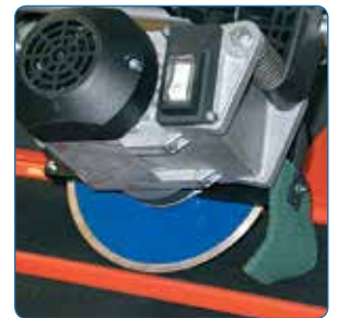
Leicht umstellbar auf Gehrungsschnitt bis 45°
